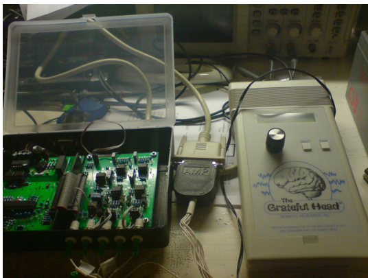
Rysunek 55: OpenEEG, wersja 2-kanalowa z podłączonym urządzeniem do kalibracji EEG.
