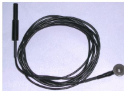
Rysunek 14: Elektroda miseczkowa.
