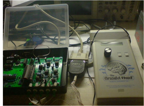
Rysunek 42: OpenEEG, wersja 2-kanalowa z podłączonym urządzeniem do kalibracji EEG.
