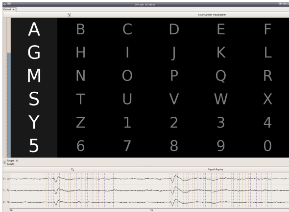
Rysunek 25: P300 Speller w OpenViBE (aplikacja wypisująca tekst myślami).
