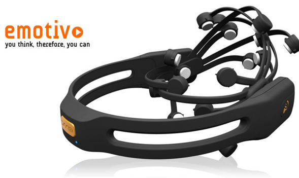
Rysunek 20: Urządzenie Emotiv EPOC – kolejne popularne urządzenie do sterowania siłą myśli.
