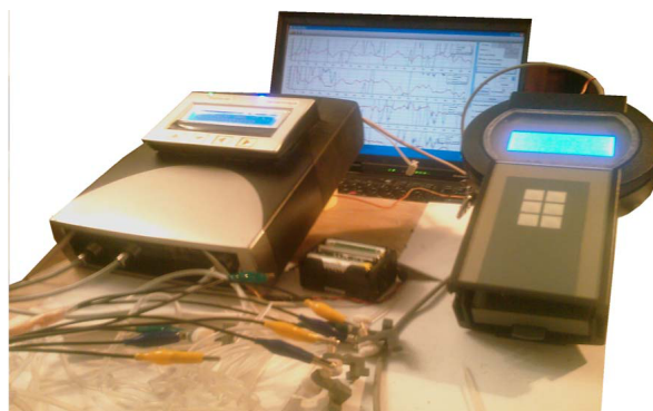
Rysunek 69: Zdjęcie kompletnego systemu do obiektywnego mierzenia smakowych potencjałów wywołanych.
