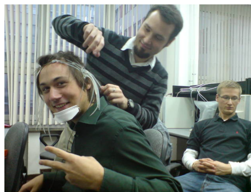
Rysunek 15: Silikonowy czepek mocujący elektrody podczas badań.
