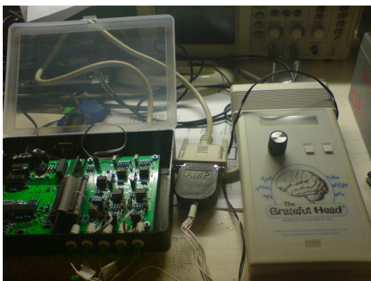
Rysunek 47: OpenEEG, wersja 2-kanalowa z podłączonym urządzeniem do kalibracji EEG.
