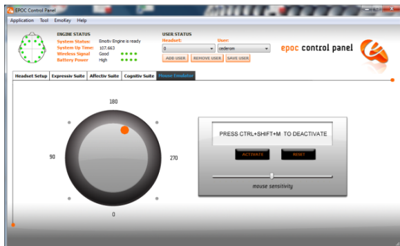
Rysunek 31: Emotiv EPOC Panel Kontrolny (wersja premium), „Mouse Emulation” jako układ sterujący wskaźnikiem myszki za pomocą akcelerometru.
